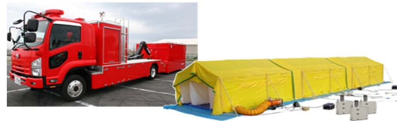
大型除染システム搭載車
